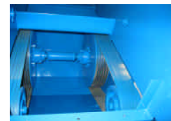
Synchron laufende Mischerwellen Vierkantwelle mit hoher Torsions- und Biegefestigkeit
