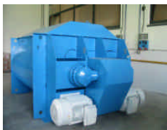
Elektromotor incl. Thermofühler zum Schutz der Motorwicklung gegen Überhitzung
