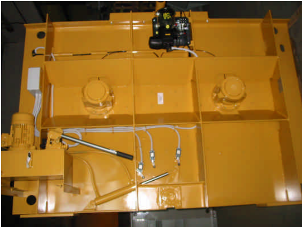
Angebaute Handpumpe für eine Notentleerung und Entleerschut
